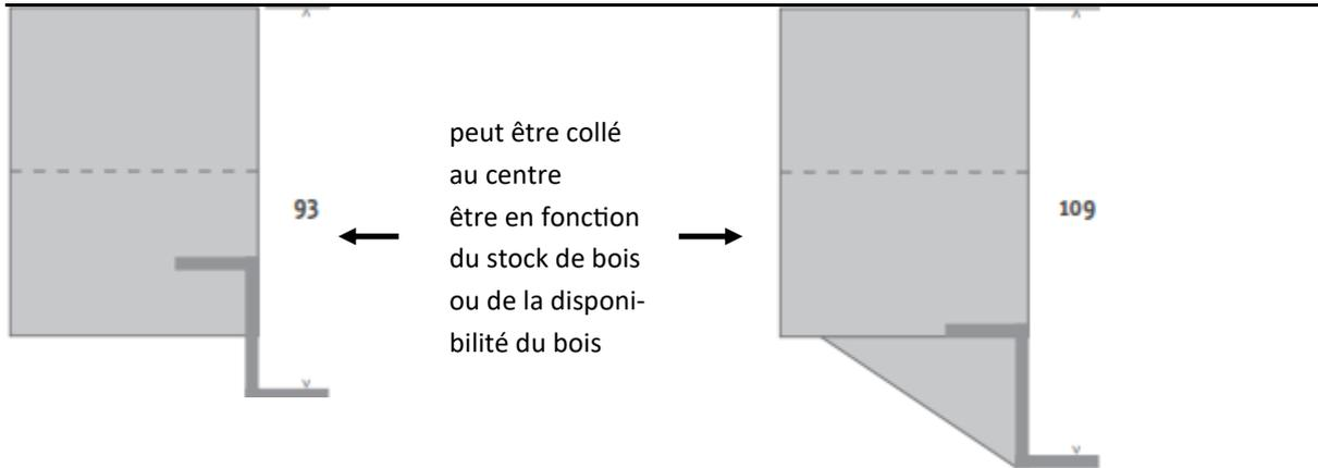
Coupe transversale du bois 70x83 mm Hauteur d'appui du sommier 83 mm Standard avec baguette triangulaire 99 mm
