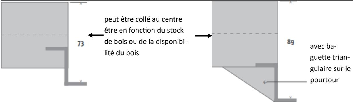
Coupe transversale du bois 80x60 mm Hauteur d'appui du sommier 93 mm Standard avec baguette triangulaire 109 mm
