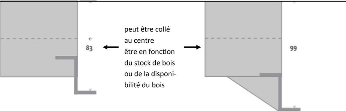
Coupe transversale du bois 80x60 mm Hauteur d'appui du sommier 93 mm Standard avec baguette triangulaire 109 mm
